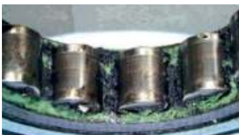
Деградация смазки, вызванная прохождением электрического тока
